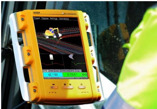
*Mit dem 3D High End System der Xsite Linie können auch komplexe Projekte schnell und effizient abgeschlossen werden*
