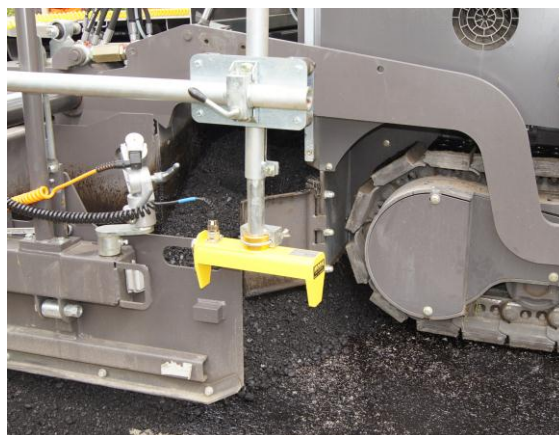
Der Ultraschallsensor Sonic-Ski tastet den Untergrund ab, damit der Asphalt eben eingebaut wird
